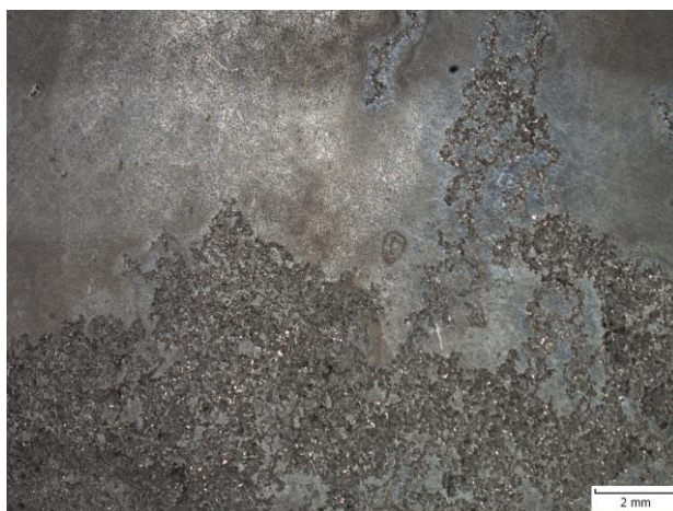
Obr. 26. Hořčíková slitina AZ91 po expozici 48 h v solné mlze 5 % NaCl, po odstranění korozních produktů
