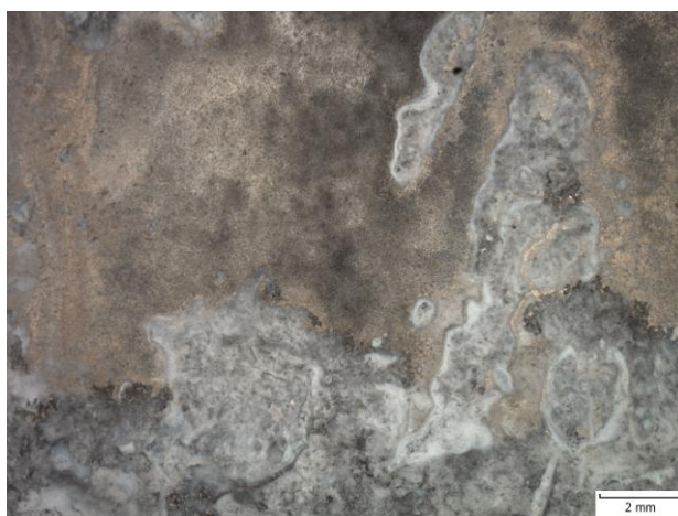
Obr. 25. Hořčíková slitina AZ91 po expozici 48 h v solné mlze 5 % NaCl, včetně korozních produktů
