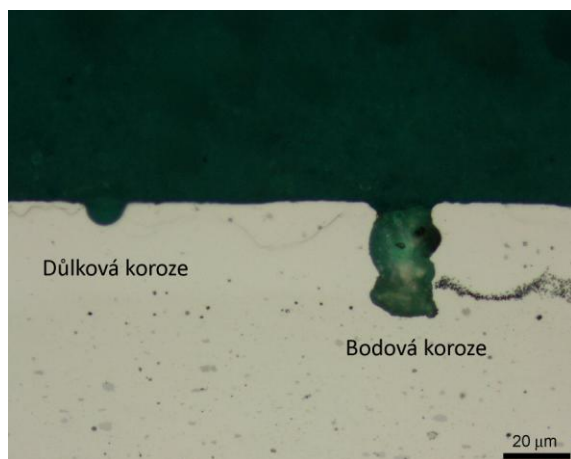
Obr. 8. Napadení důlkovou a bodovou korozí hliníkové slitiny AlCu4Mg, expozice 1000 h v solné mlze 5 % NaCl
